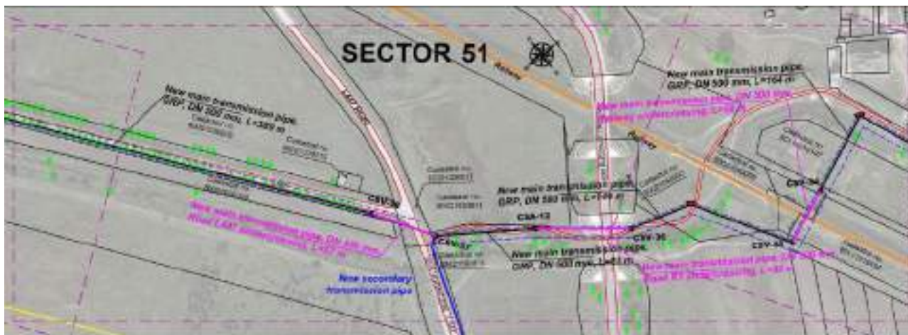
Figura 8.3. Intersecția 1 a drumului R1 cu MTP
